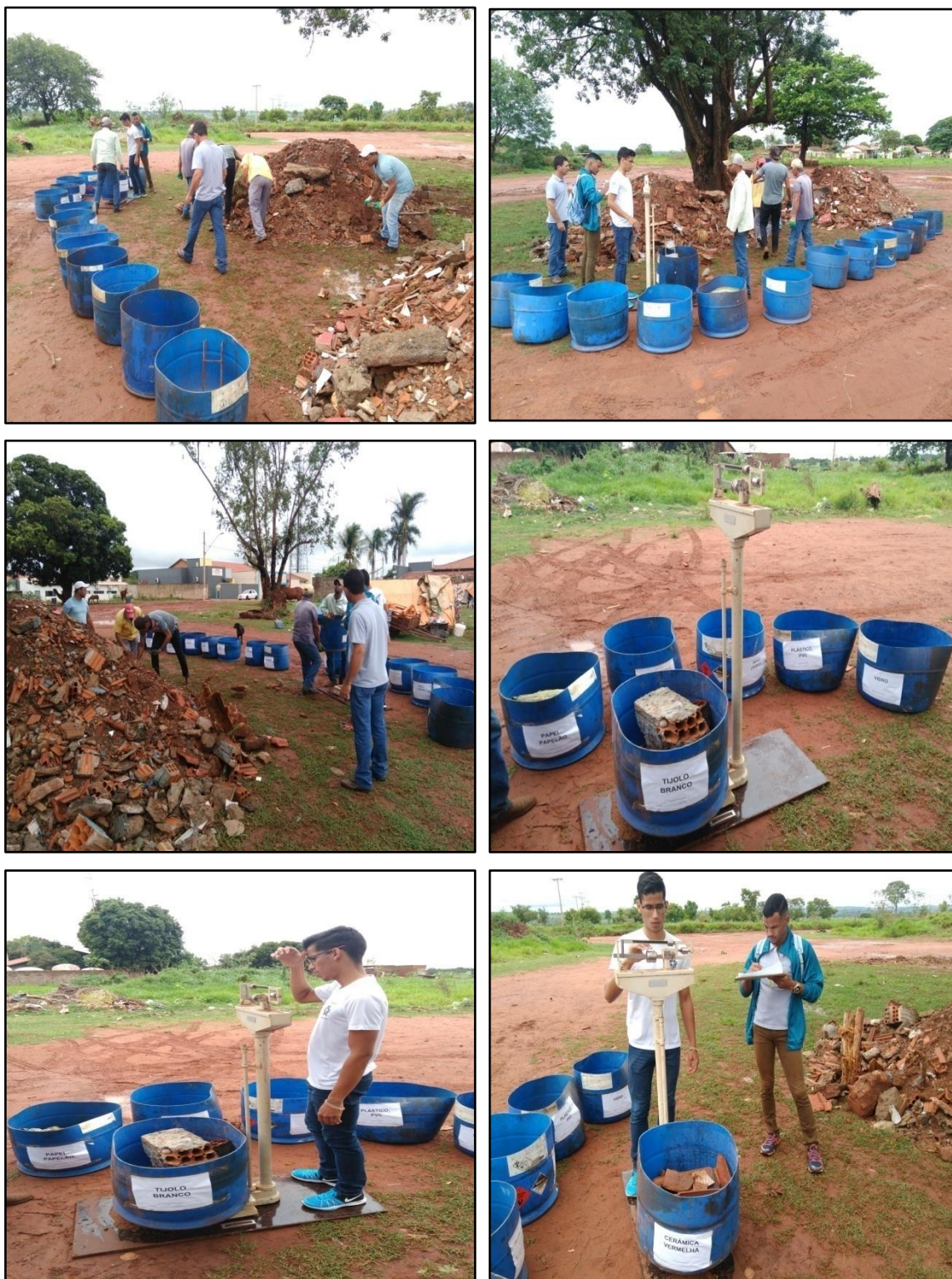
Figura 90: Estudos de gravimetria dos resíduos sólidos de construção civil e de demolição. Da esquerda para a direita: amostragem, separação da amostra, segregação e pesagem por tipologia de resíduos.
