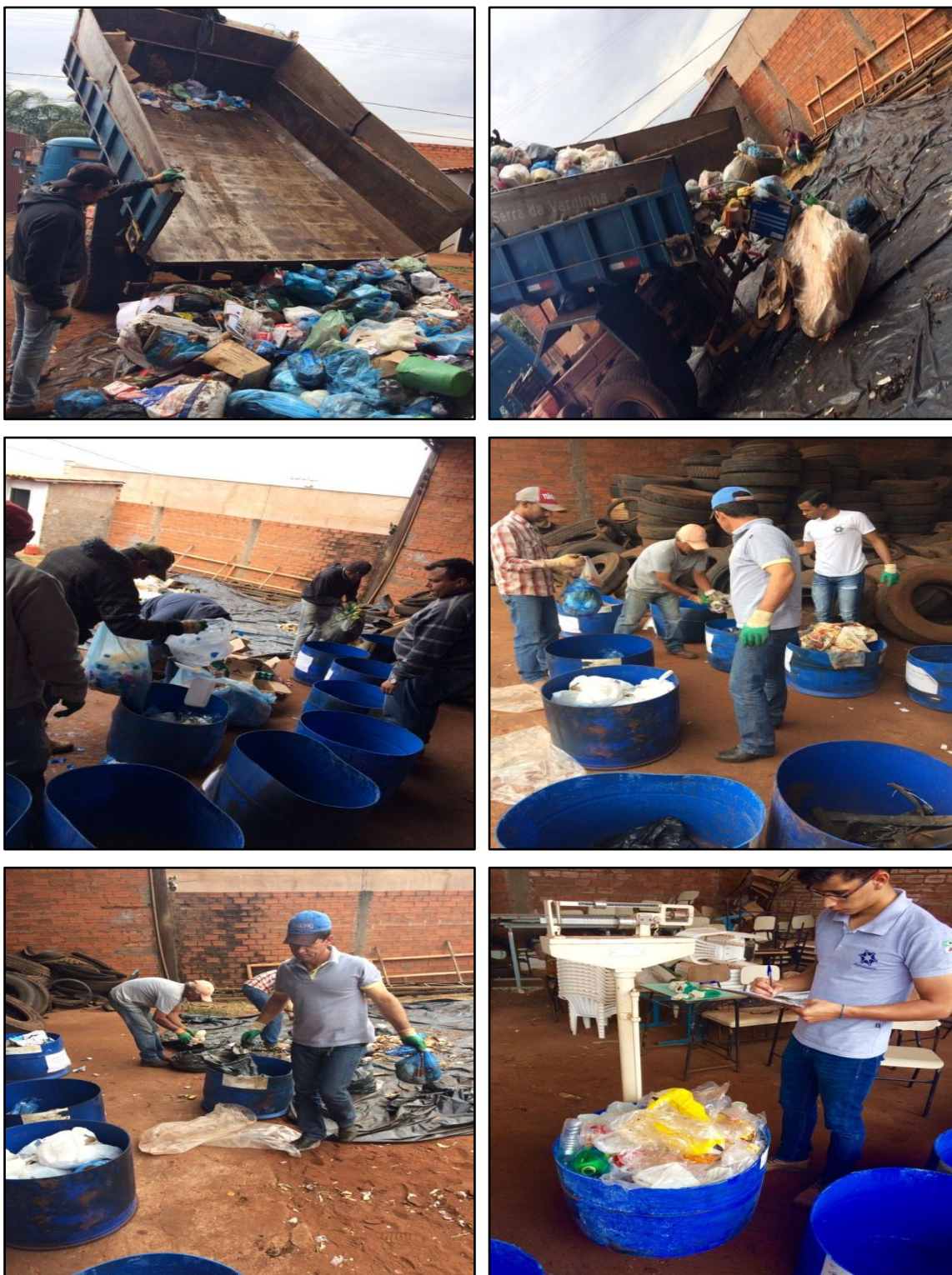
Figura 88: Estudos de gravimetria dos resíduos sólidos domiciliares, de empreendimentos comerciais e prestadores de serviços. Da esquerda para a direita: amostragem, separação da amostra, segregação e pesagem por tipologia de resíduos.
